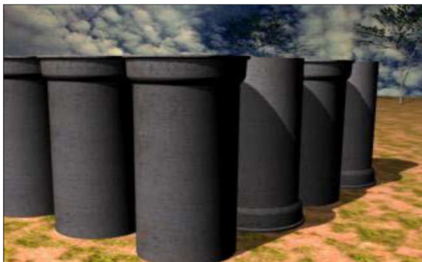
Figura 8 - Tubos na posição vertical
