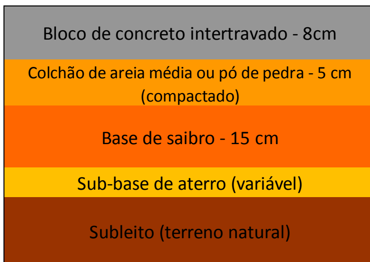
Figura 16 - Camadas pavimentação com blocos de concreto intertravado
